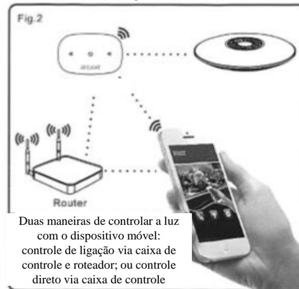
Duas maneiras de controlar a luz com o dispositivo móvel: controle de ligação via caixa de controle e roteador; ou controle direto via caixa de controle
